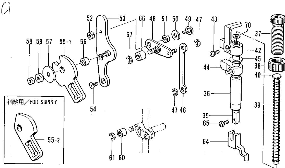
電磁、スナップ・ホックツケヨウ / SOLENOID, SNAP AND HOOK TYPE
