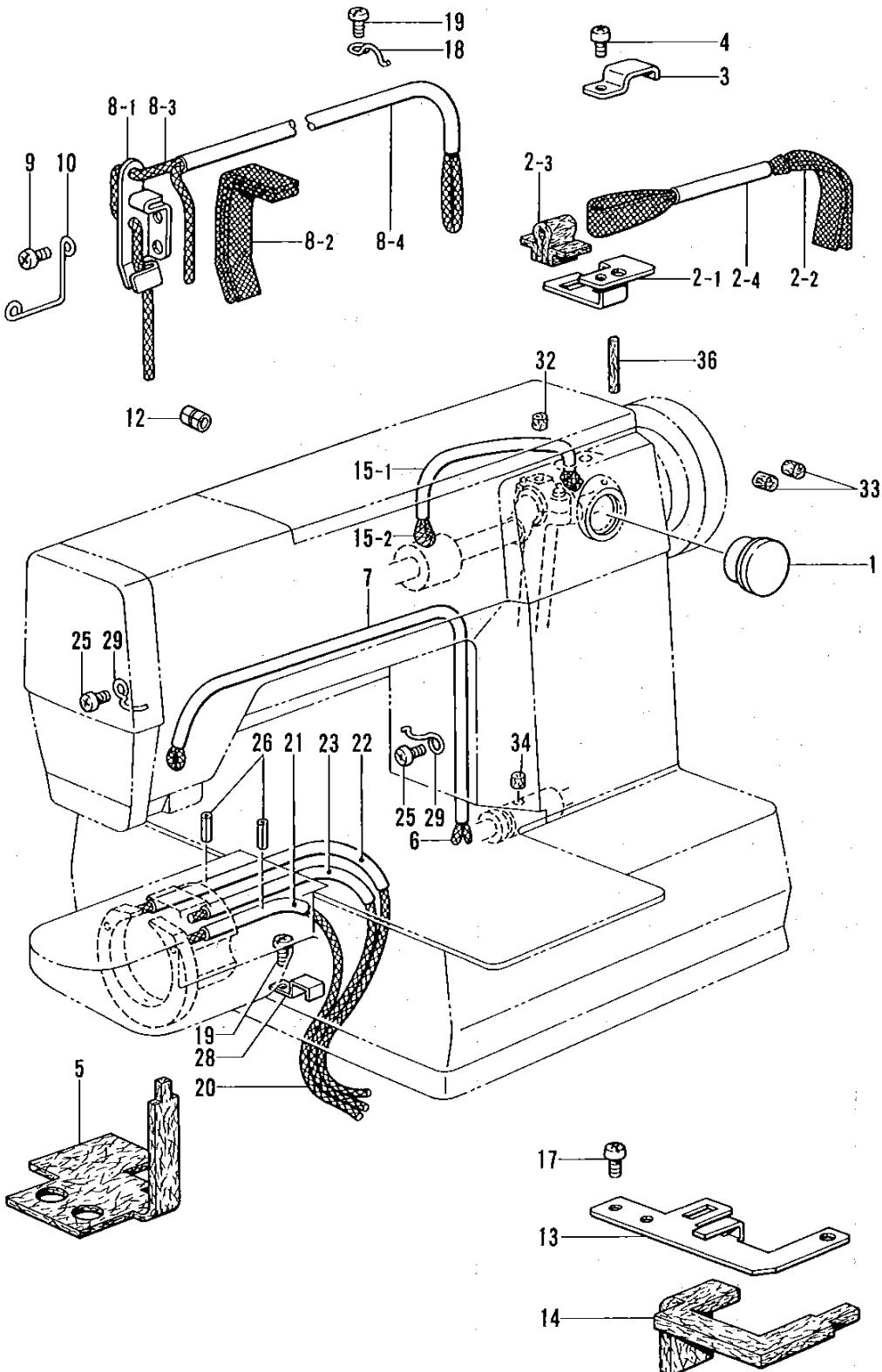
H. 給油・潤滑関係/Lubrication/Schmierung/
