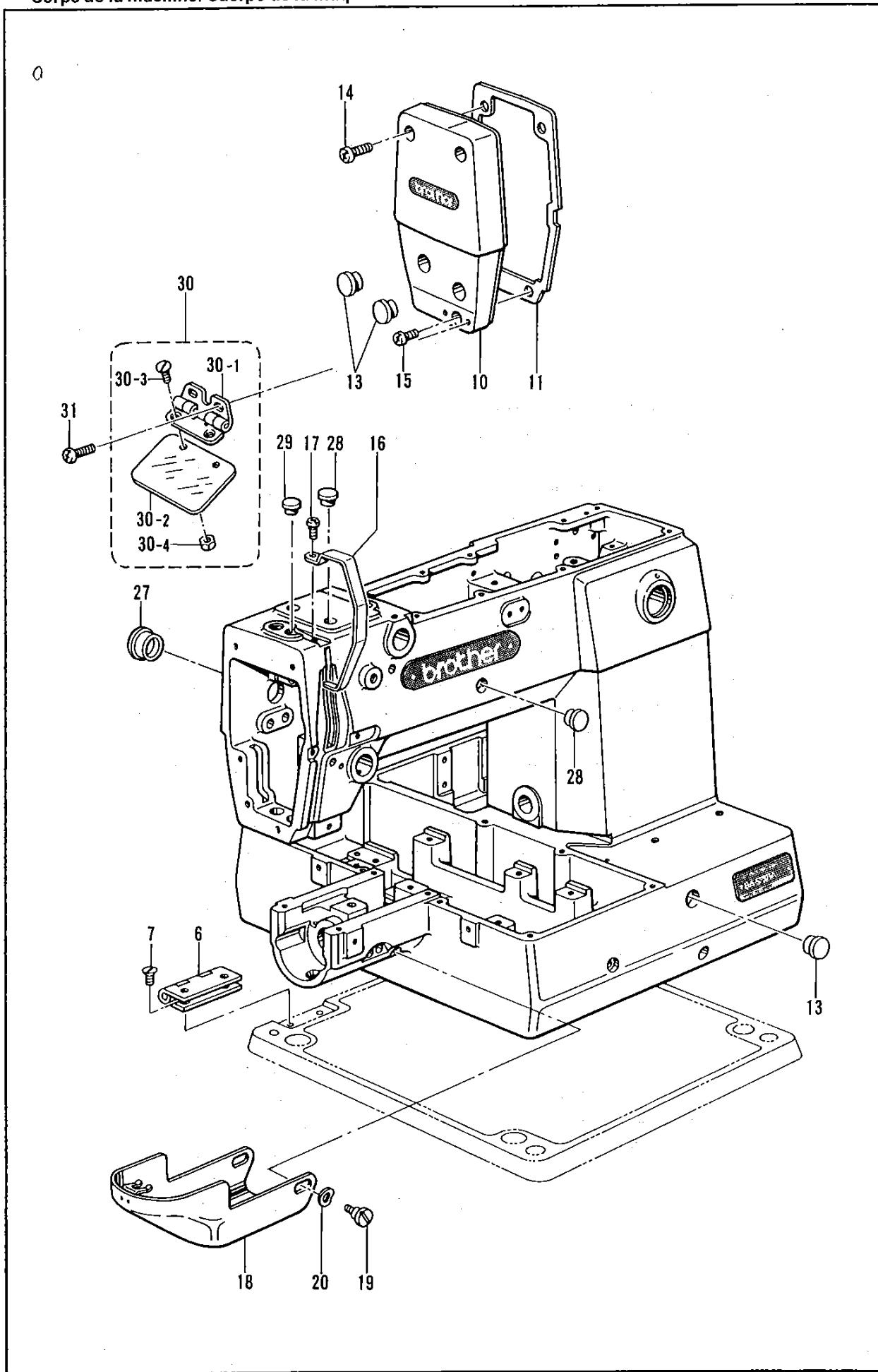
A. 主体関係 /Machine body/Maschinengehäuse/
