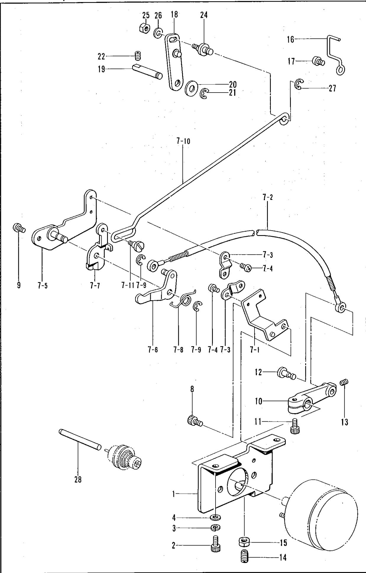
P. 糸締メ関係/Thread nipper mechanism/Fadenspannvorrichtung/
