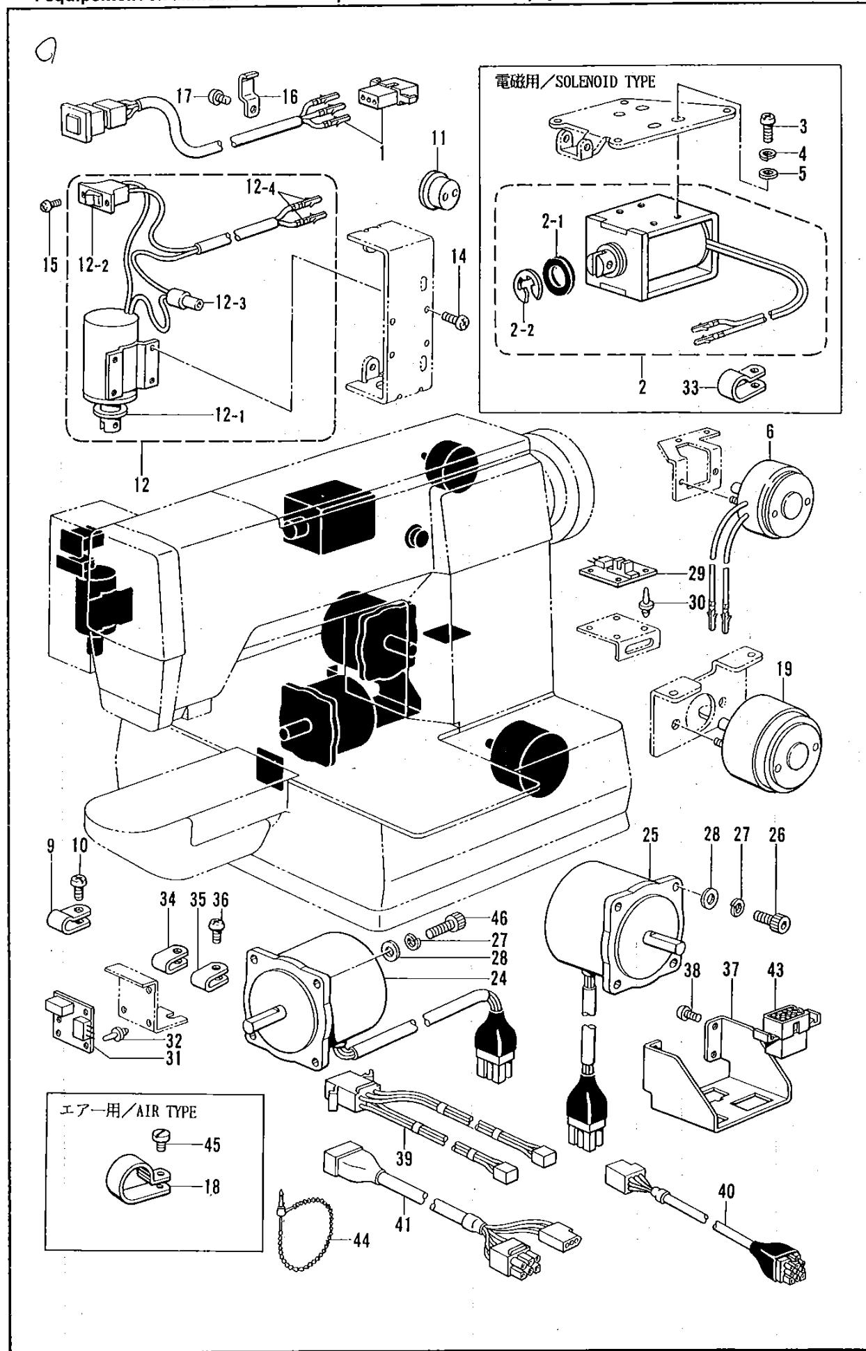
Q. 電装品関係 / Power supply equipment mechanism / Schaltkasten / Mécanisme de l'équipement en alimentation électrique / Mecanismo de la equipo de alimentación de corriente
